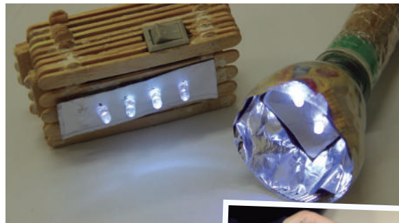
Placas com LED transformaram-se em lanternas.
